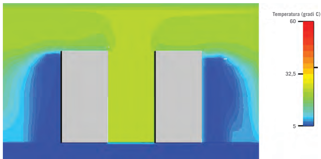
FIGURA 10: PROSPETTIVA LATERALE OSSERVANDO L'AREA CENTRALE DEL CORRIDOIO CALDO.
