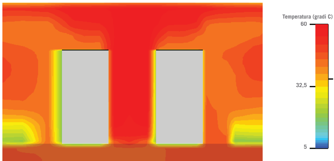
FIGURA 11: CARICO DI 5.000 WATT PER ARMADIO TRASCORSI 120 SECONDI DALLA PERDITA DI RAFFREDDAMENTO.
