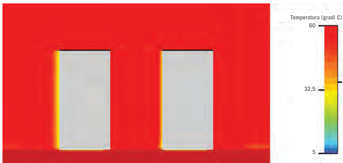
FIGURA 13: CARICO DI 5.000 WATT PER ARMADIO TRASCORSI 240 SECONDI DALLA PERDITA DI RAFFREDDAMENTO.
